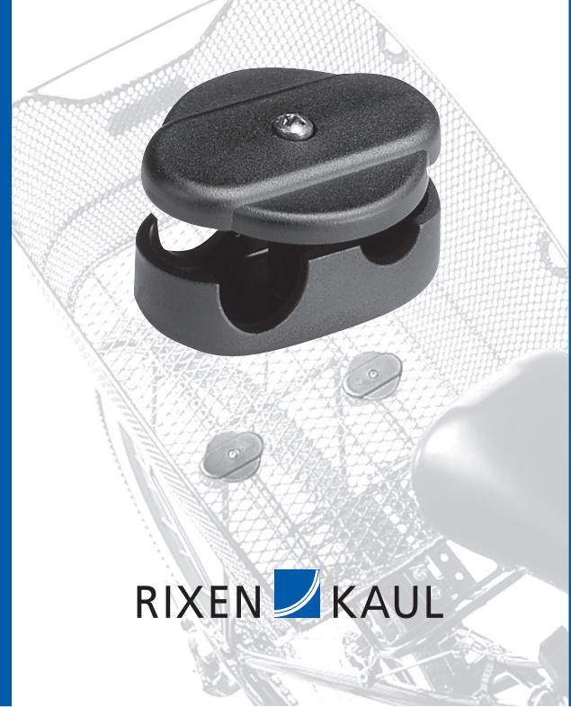
**Montage bei Boxen** Position so wählen, daß der Deckel der Box noch bequem zu öffnen ist (Abstand zum Sattel beachten). Mittellinie auf der Boxenunterseite markieren. Bohrlöcher anzeichnen. (Entfernung von der Mittellinie =  $\frac{1}{2}$  Gepäckträgerbreite + 12mm). Zwei Löcher  $\varnothing$  5mm bohren.
