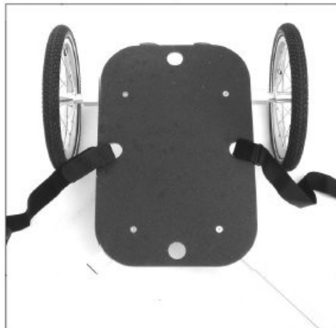
22. Fixez les sangles sur les trous. Une fixée côté velcro et une avec le côté à boucle.
