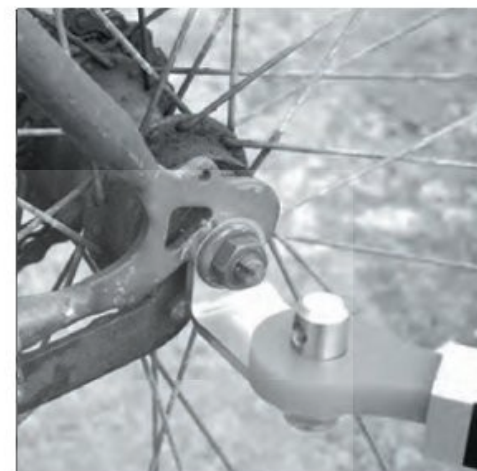
13. Insérez l'extrémité du bras de remorquage sur la fixation.
