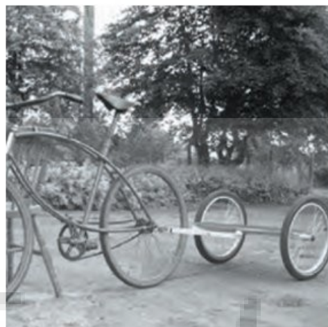
11. La fixation Y-Frame s'attache sur votre axe de roue arrière du côté gauche
