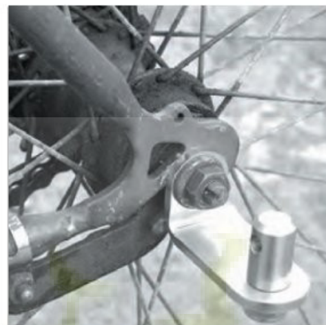
12. Retirez l'écrou ou la poignée de serrage rapide de votre axe. Insérez la fixation puis revissez.
