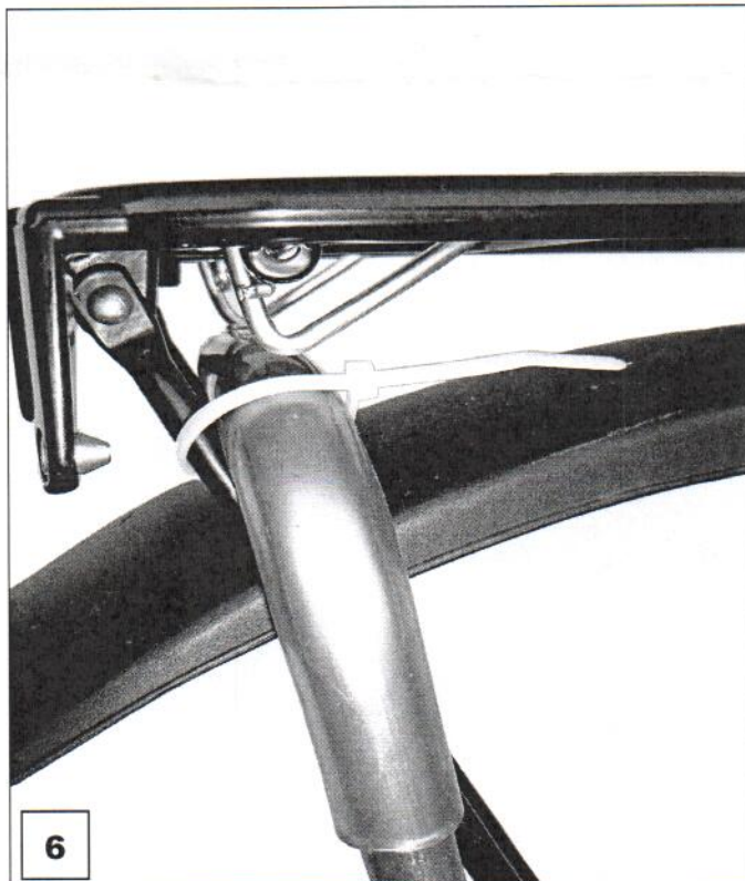
6. Mit Kabelbinder U-Rohr an Gepäckträger- Strebe fixieren. Schritt 2 bis 6 auf der linken Fahrradseite durchführen.
